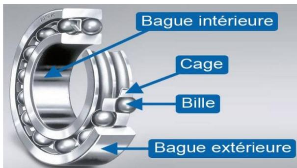
Un roulement est un dispositif qui permet un mouvement de rotation entre deux objets. On les trouve généralement dans les machines où deux éléments tournent l'un par rapport à l'autre selon un axe de rotation défini. Il existe de nombreux types de roulements, chacun ayant ses propres avantages et inconvénients. Parmi les types les plus courants, on trouve les [roulements à billes](#), les [roulements à rouleaux](#) et les butées ([à billes](#), [à aiguilles](#), [à rouleaux](#)).
